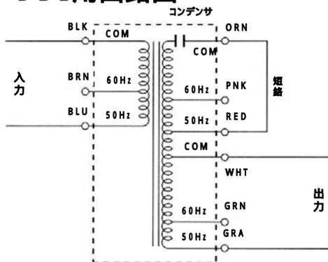
コンデンサは内蔵されております。コンデンサ巻線は、外部にて接続してご使用下さい。他の使用しないリード線は絶縁して下さい。
